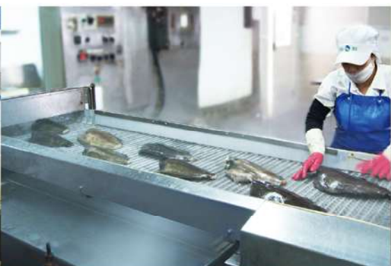
I.Q.F急速冷凍設備
